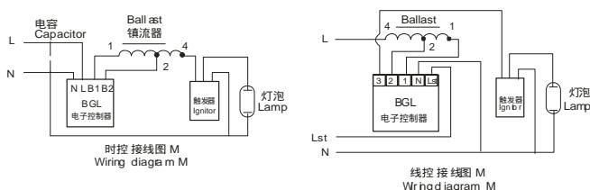
C: 通电后满功率—60%功率，延续至断电。
