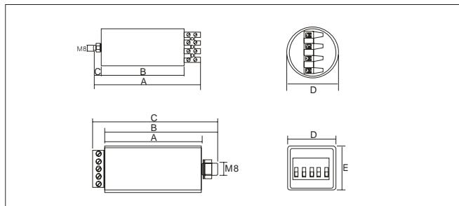
变功率电子控制器是一种与镇流器配合使用，能够按照预置的时间自动变换不同灯功率的电子装置。在照明使用时，它可以按照不同的照度和使用要求，自动转换灯功率，可以节省大量的电能。它是一种全新的节能型照明产品，具有极大的推广意义。
