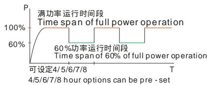
B: 通电后满功率— 60%功率— 满功率，延续至断电。
