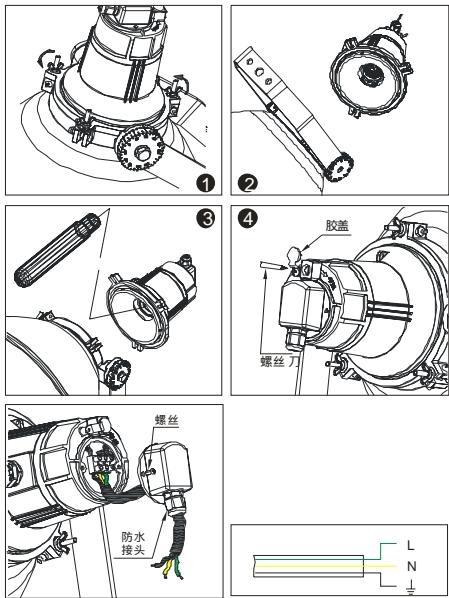
打开灯具上盖把电源线穿过防水接头后，接入接线端子。
