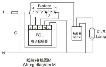
A: 通电后满功率 — 60%功率 — 满功率 — 60%功率.....循环至断电。
