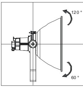
按照图示把灯具支架固定到需要安装的地方，注意：灯具不能水平旋转，安装时必须注意安装方面。
